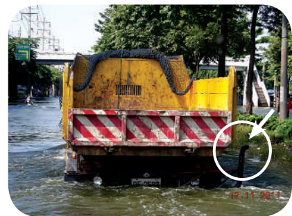
รูปที่ 11 การการต่อท่อไอเสียของรถเก็บขนขยะมูลฝอยให้สามารถใช้งานได้เมื่อเกิดอุทกภัย
